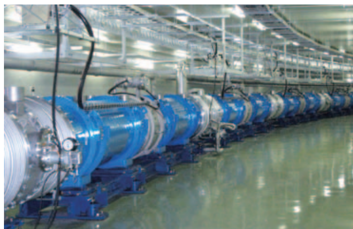
J-PARCのニュートリノビームラインに設置された超伝導磁石システム
