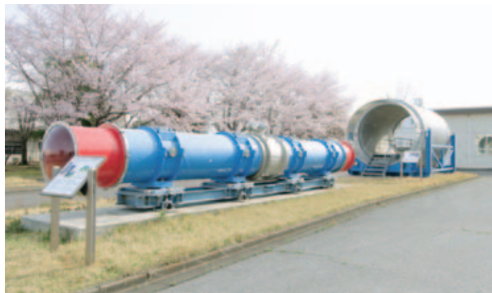
ニュートリノ実験用超伝導磁石および TRISTAN実験用超伝導検出器ソレノイド
