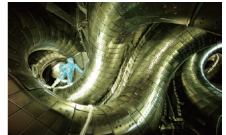
核融合科学研究所 プラズマを閉じ込める真空容器内部
