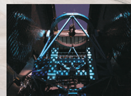
口径8.2メートルのすばる望遠鏡と、 望遠鏡上部に搭載された超広視野主焦点 カメラHSC (Credit: 国立天文台、撮影: 藤原英明)
