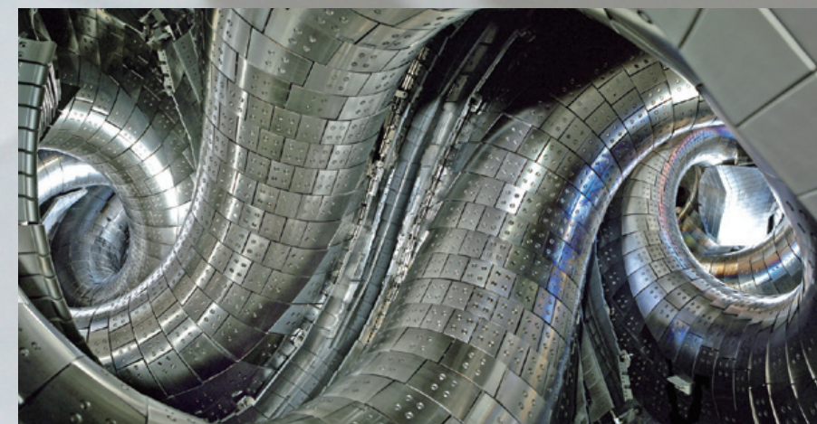
超高温プラズマを閉じ込める真空容器内部
